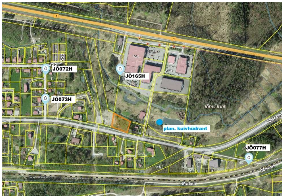
Joonis 4 Olemasolevad hüdrandid ja planeeritav kuivhüdrant. Alus: Maa- ja Ruumiamet, e-ehituse portaal
